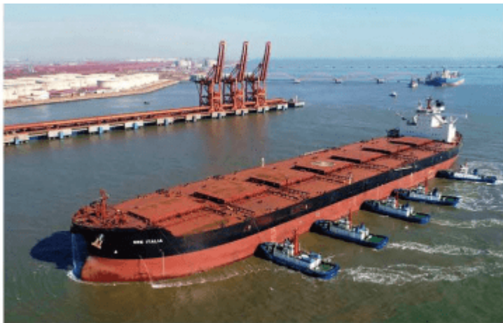
图 3-2-2 一艘 40 万吨级巨轮准备靠泊在唐山港曹妃甸矿石码头
