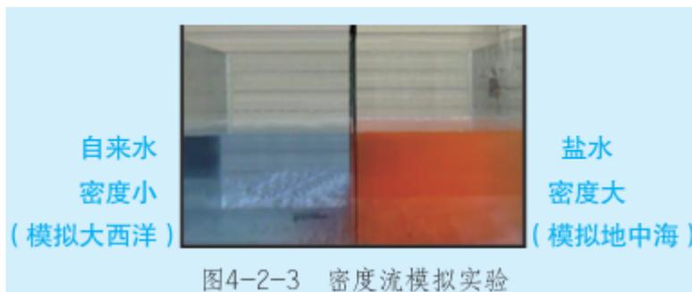
3.密度流模拟实验。如图4-2-3，将隔水板插入水槽中间，在一侧加入红墨水和食盐，另一侧加入蓝墨水，待食盐充分溶解后抽出隔水板。观察并描述水槽中两部分水的流动状况，思
