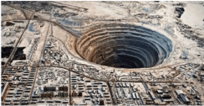
俄罗斯米尔钻石矿遗留的矿坑面积巨大（直径约1 200米，深约525米），是人类工业文明的重要遗址。
