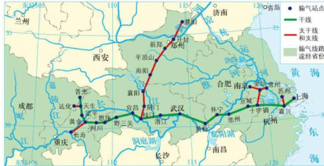
图2-2-14 “川气东送”工程示意 1:16 000 000
