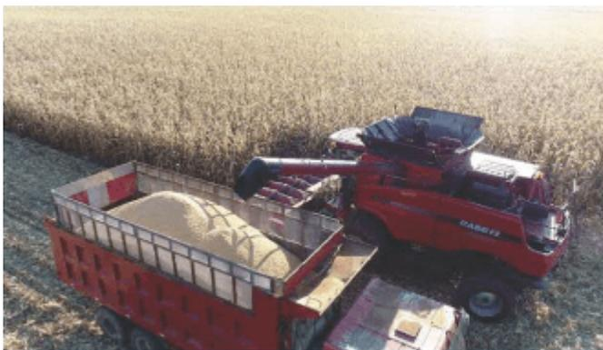
收割机械在卫星导航的指引下进行作业，玉米收割、秸秆粉碎、脱粒等一次性完成。同时记录收获玉米的重量、水分、收割面积等信息。
