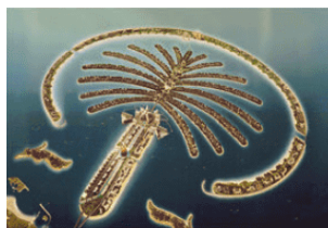
人工岛： 朱美拉棕榈岛是阿联酋迪拜棕榈岛工程所建的第一个人工岛，目的是解决自然沙滩被开发殆尽的问题。该岛始建于2001年，由一个棕榈树干形状的主岛、17个棕榈叶形状的半岛和顶部新月形防波堤三部分组成。棕榈树的形状能最大限度地扩展沙滩面积。
